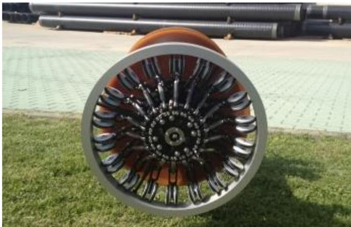
Il Caliper Pig misura continuamente il **diametro interno della tubazione** mediante un insieme di sensori che, caricati a molla al fine di tenerli in contatto con la parete della condotta, forniscono copertura ottimale della circonferenza interna. Le Drive-Cup in poliuretano, estremamente flessibili, consentono allo strumento di procedere agevolmente attraverso la tubazione. Il Caliper Pig è in grado di passare con riduzioni del diametro della condotta fino al 25%.
