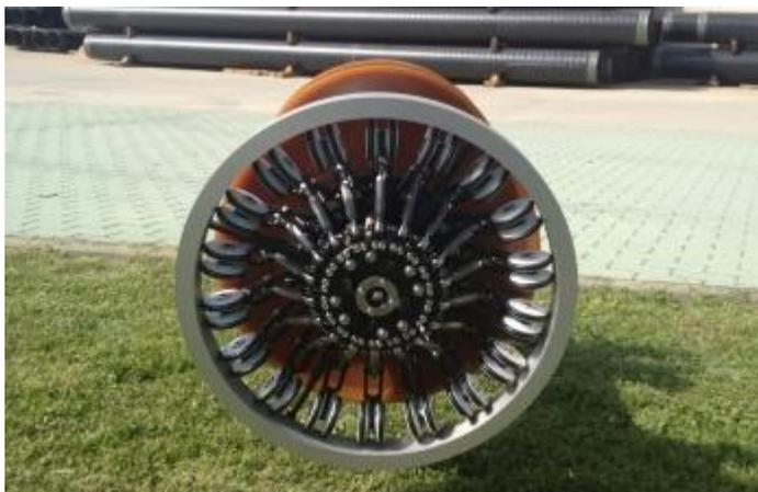
Профилемер Калипер непрерывно измеряет **внутренний диаметр трубопровода** при помощи пояса измерительных рычагов, подпружиненных для поддержания контакта со стенкой трубы и обеспечивают оптимальный охват внутренней окружности. Чрезвычайно гибкие полиуретановые манжеты обеспечивают высокую проходимость профилемера по трубе в потоке транспортируемой среды. Профилемер способен проходить сужения диаметра вплоть до 25%.
